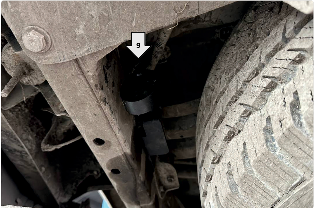
9 Установить резиновое крепление глушителя на кронштейн. Аналогично противоположную сторону.
