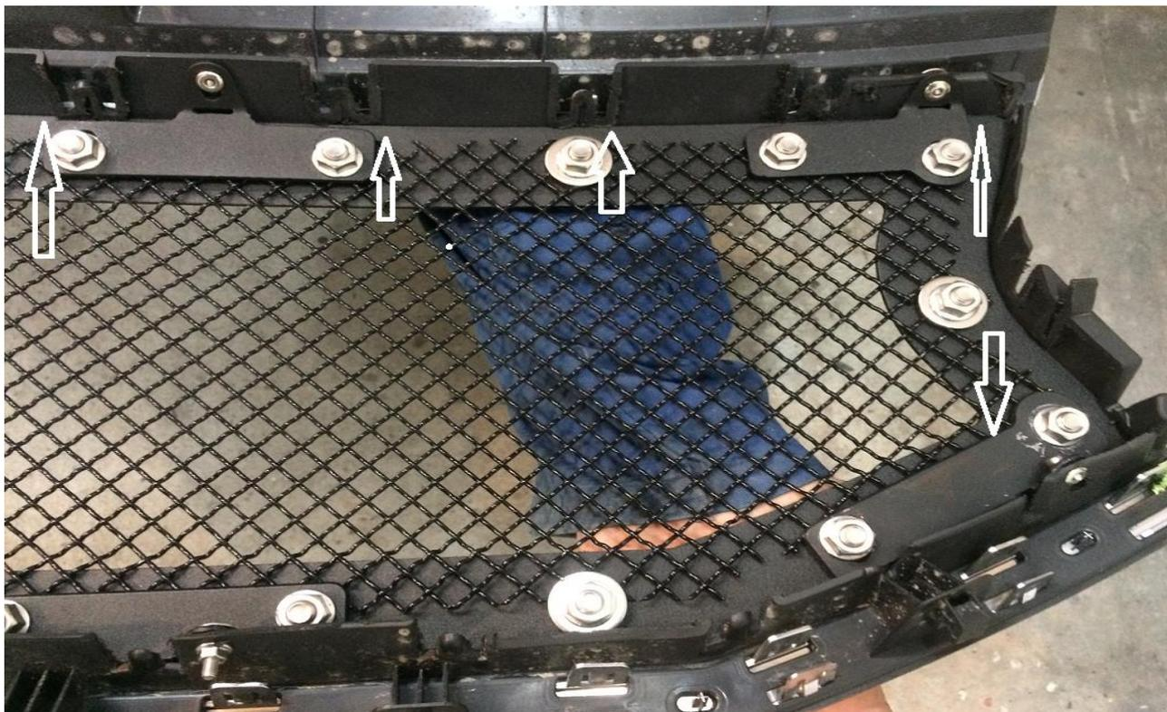
6. Нижние центральные кронштейны прикручиваем на комплектные болты с гайкой. Это позволяет нам регулировать решетку, выставляя по контуру
