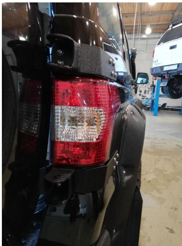
2. Для установки необходимо приложить кронштейны к местам крепления калитки, как показано на фото выше. Отметить места крепления. И просверлить отверстия в крыльях, сверлом диаметром 11.
