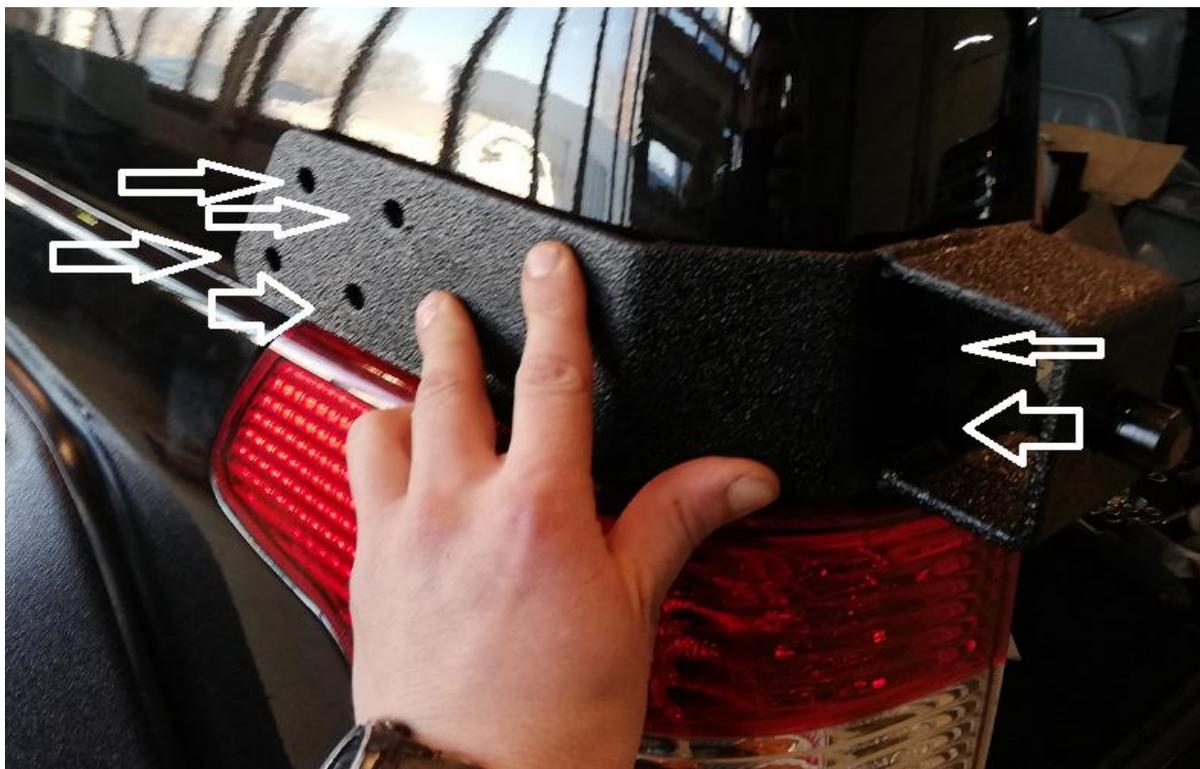
3. Прикручиваем кронштейны, предварительно обработав отверстия грунтом и нанести герметик, что бы избежать дальнейшего попадания воды. Прикручивая кронштейны с внутренней стороны использовать закладные, **позиция 15,16**
