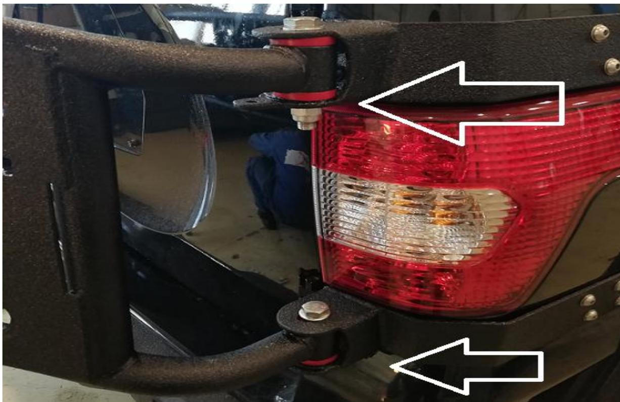
Кронштейны крепления калитки, в местах крепления имеют прорези для ее регулировки в двух плоскостях.
