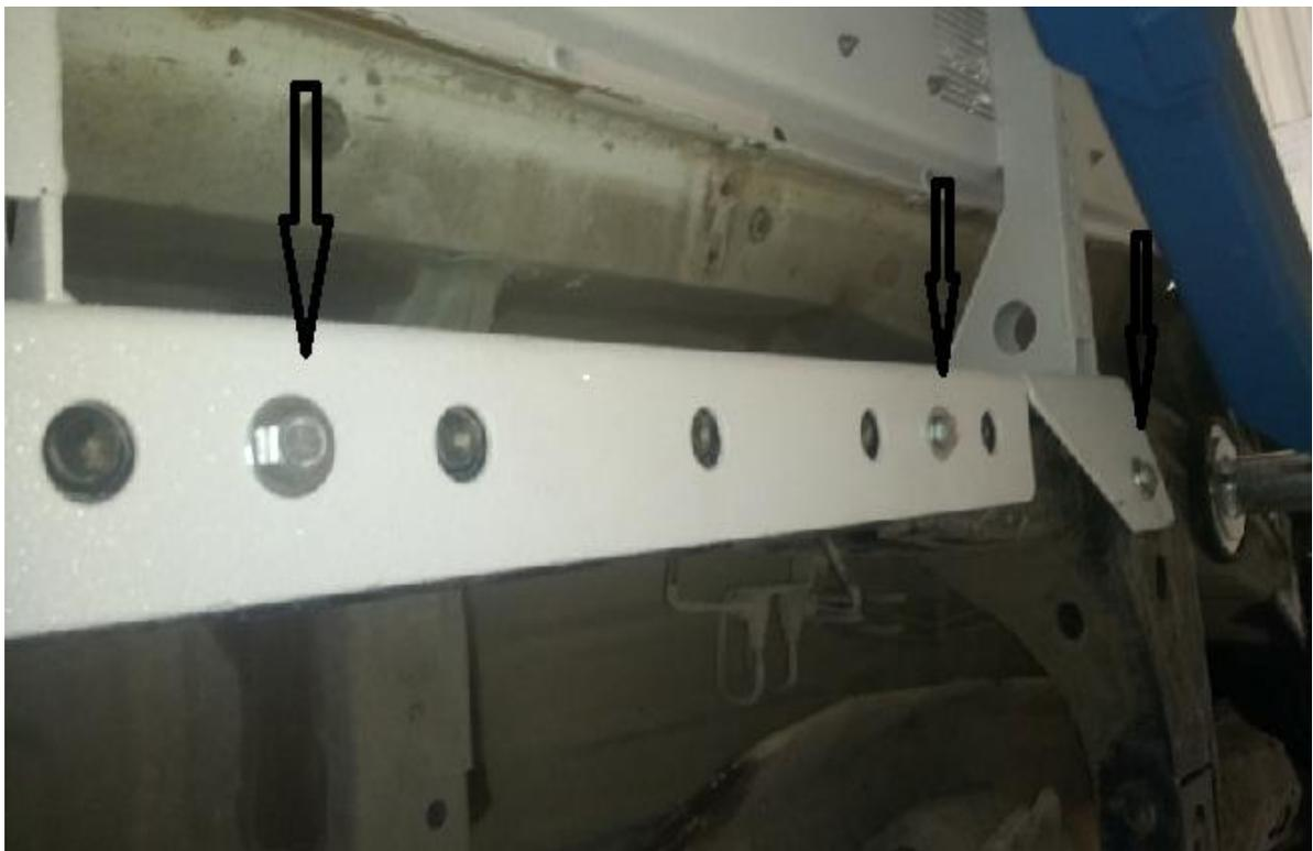
7. Крайний кронштейн бампера крепим на кронштейн рамы, прикручиваем комплектным крепежом, позиция **5,6,7,8**,
